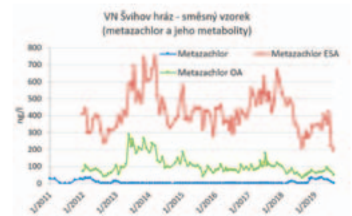
Obrázek 4. Vývoj koncentrací metazachloru a jeho metabolitů na profilu VN Švihov hráz, období let 2011–2019
