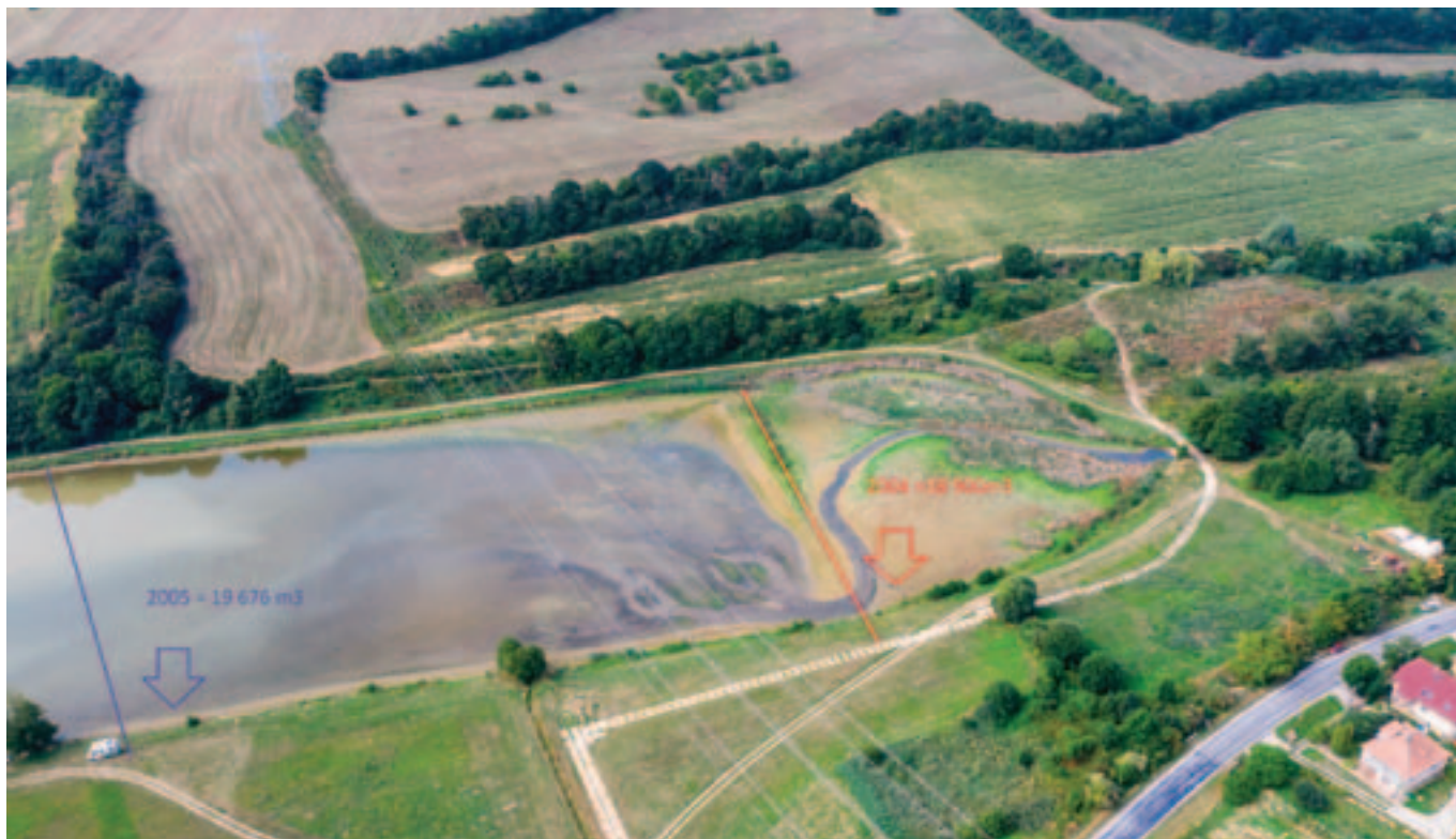
Obrázok 2. Odstraňovanie nánosov – sedimentačná nádržka na vtoku
