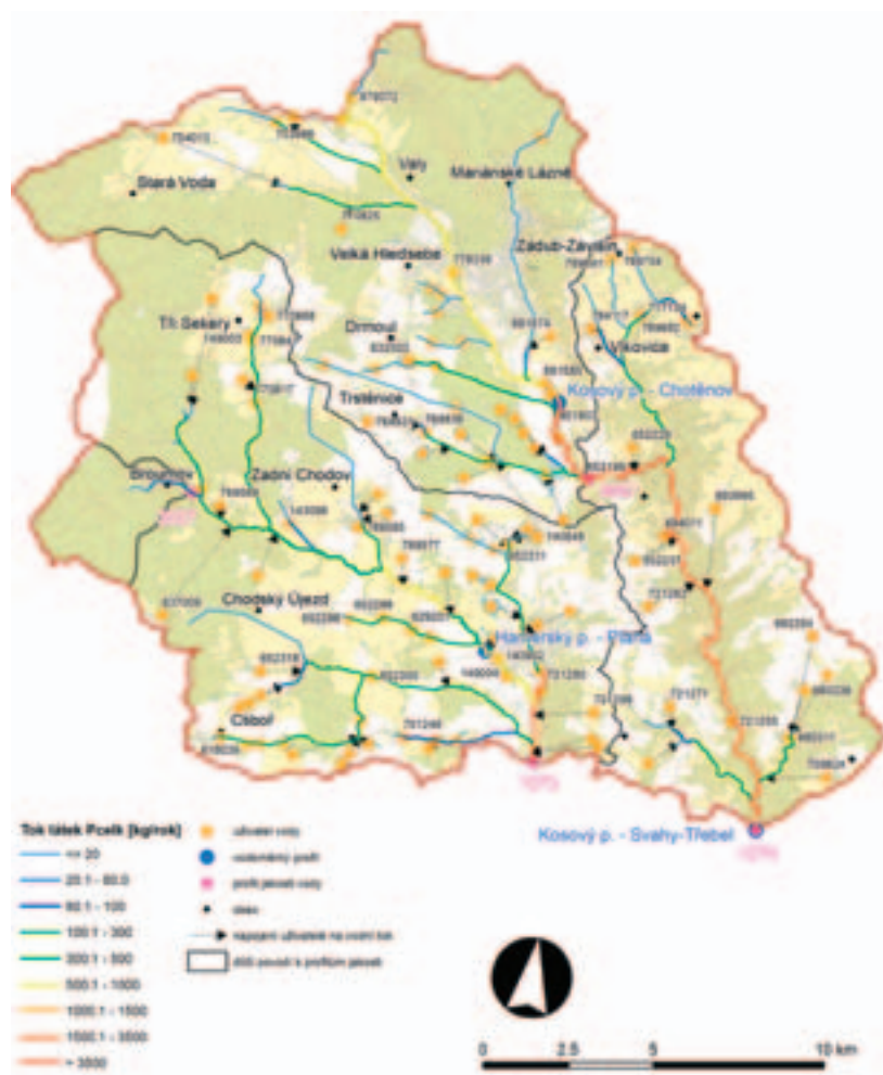
Obrázek 3. Látkový tok Pcelk (kg/r) v říční síti povodí Hamerského a Kosového potoka. Simulace referenčního období 2012–2017
